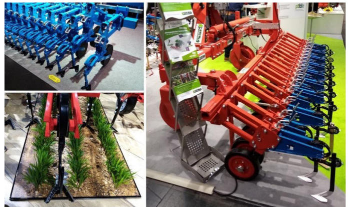
Obr.: Pro kultivaci plodin vysévaných do úzkých řádků se využívají především plečky se šípovými podřezávacími radličkami (foto Brant).
