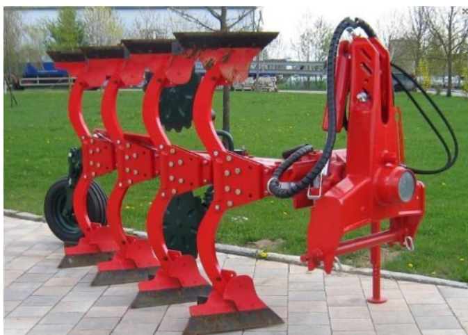
Obr.: Omezení obracího efektu odhrnovačky zvyšuje regulaci vytrvalých plevelů především v systémech ekologického zemědělství (zdroj: https://zobel-stahlbau.de ).
