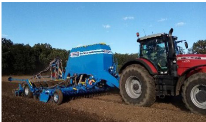
Obr.: Stroje se systémem přípravy půdy při setí využívající pasivně pracující pracovní nástroje (foto Brant).
