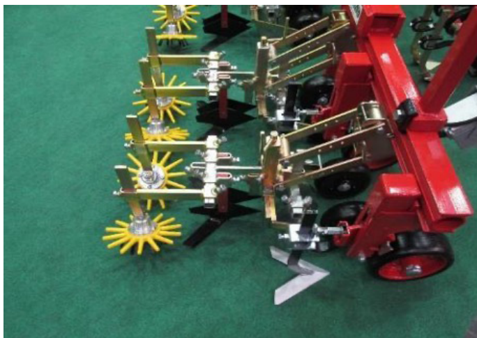
Obr.: Prstová kola jsou samozřejmě kombinována na rámech pleček s pracovními nástroji pro meziřádkovou kultivaci (foto Brant).
