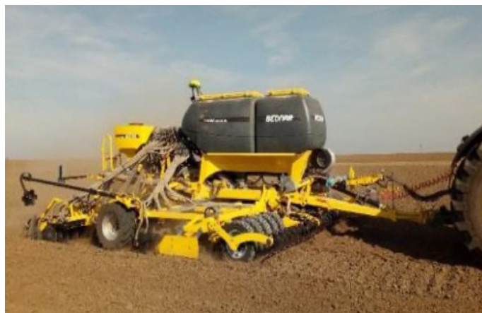
Obr.: Secí stroje bez sekcí pro přípravu půdy většinou vyžadují kvalitní předseťovou přípravu půdy (foto Brant).
