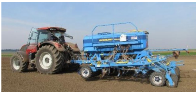
Obr.: Secí stroje pro setí do zpracované, či částečně zpracované půdy osazené výsevními radličkami osazenými křídly (foto Brant).
