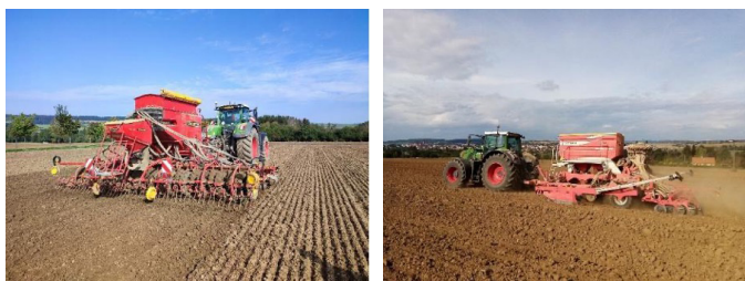
Obr.: Pracovní kypřicí sekce pro přípravu půdy u secích strojů zajišťují urovňání povrchu půdy, tvorbu seťového lože a vhodné agregátové prostorové uspořádání půdy nad seťovým ložem (foto Brant).
