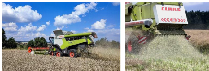
Obr.: Pro dokonalé zapravení slámy do půdy je důležité její rovnoměrné rozmístění na pozemku (foto Brant).
