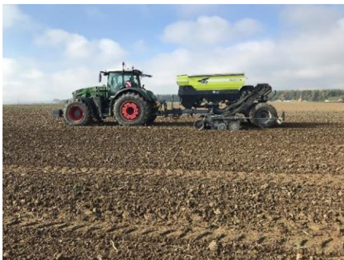
Obr.: Secí stroje pro setí do nezpracované půdy osazené s kotoučovými výsevními botkami (foto Brant).
