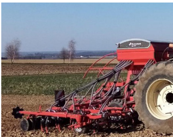
Obr.: Secí stroje pro setí do zpracované, či částečně zpracované půdy osazené dlátky (foto Brant).
