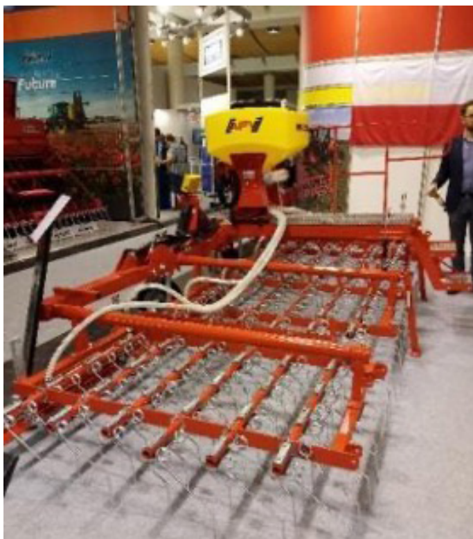
Obr.: Prutové brány lze osadit zásobníky osiv pro výsev podsevových meziplodin či jiných pevných látek (foto Brant).
