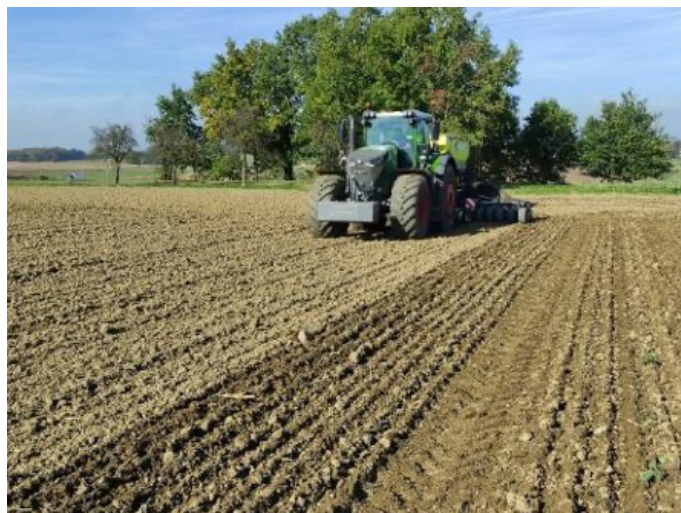
Obr.: Použití secích strojů pro výsev do nezpracované půdy pro setí do kypré a celoplošně zpracované půdy, kde může v důsledku váhy stroje a použitého tažného prostředku vznikat riziko tvorby hlubokých kolejových stop, kde rostliny problematicky vzházejí (foto Kasl).
