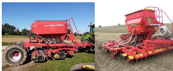
Obr.: Secí stroje pro setí do nezpracované půdy osazené s kotoučovými výsevními botkami (foto Brant).
