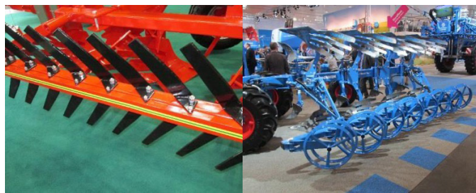
Obr.: Pro urovňání hrubé brázdý při orbě lze využít rozdílné technické konstrukce (foto Brant).
