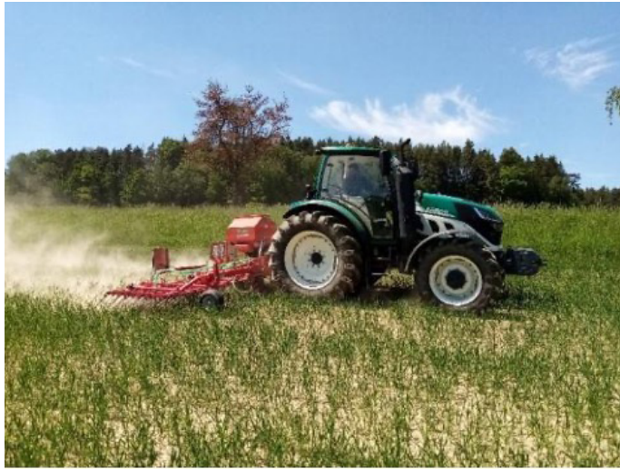
Obr.: Kypřicí a odplevelující efekt zajišťují pružné pruty umístěné v několika řadách na rámu stroje (foto Brant).
