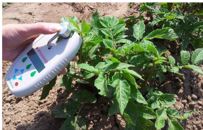
Obrázek 4: Stanovení indexu chlorofylu v listech bramboru pomocí chlorofyloměru CCM 200 Plus.
